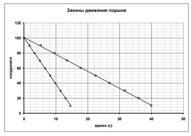
Так как графики являются прямыми линиями, то движение поршня с достаточной точностью можно считать равномерным.
