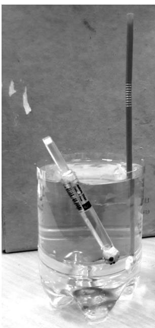
**Приборы и оборудование:** сосуд с водой, корпус от ручки (используется в качестве модели поплавка), леска, набор обрезков свинцовых грузил (при необходимости вы можете дробить кусочки свинца самостоятельно – они достаточно легко режутся ножом и ножницами), одно целое грузило, трубка пластиковая для коктейля, пластилин, линейка, транспортир.
