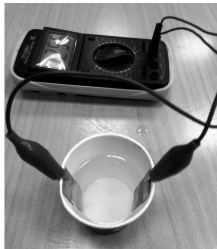
2.1 Переключите мультиметр в режим измерения сопротивлений. Запишите показания мультиметра (в килоомах) при всех возможных диапазонах измерения мультиметра и двух полярностях подключения.
