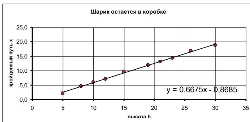
Для второго случая, когда шарик ударяет по торцу коробки и отскакивает, получены следующие результаты.
