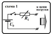
напряжение на нагрузке с помощью данной цепи питания, если ее сопротивление равно  $R_{\scriptscriptstyle x}$ .
