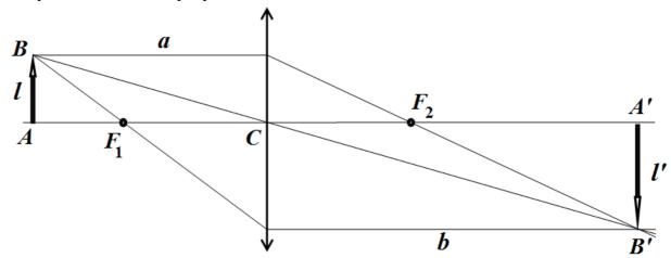
Здесь AB - предмет, который находится на расстоянии |AC|=a от линзы; A'B' - его действительное изображение, которое находится на расстоянии |CA'|=b от линзы. Линейным увеличением называется отношение размера изображения к размеру предмета
