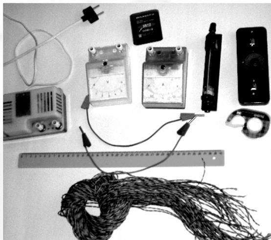
Выберите два одинаковых соединительных проводка (в наборе они должны быть отмечены). В дальнейшем амперметр и вольтметр подключайте к другим приборам только с помощью этих выделенных проводков – вам необходимо будет определить их сопротивление!
