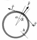
В формулах (3)-(4) обозначено: R - радиус цилиндра, h - толщина его стенок,  $\sigma_{np.}$  - предел прочности стали,  $S_0$  - площадь выделенной полоски,  $S_1$  - площадь ее боковых торцов. Записывая условие равновесия выделенного элемента в проекции на радиальное направление, получим
