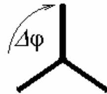
предполагаем, что все лопасти вентилятора одинаковы). Таким образом, условие будет выполнено при  $2\pi n\tau = \frac{2\pi}{3}k$ , или при частотах вспышек  $\nu = \frac{1}{\tau} = \frac{3n}{k}$ . Так как минимальная частота стробоскопа равняется  $2\Gamma_{ц}$ , то максимальное значение  $k_{max} = 15$ .
