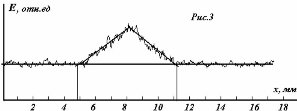
Из этого графика находим, что длина импульса примерно равна  $\delta l \approx 6 \text{ мм}$ , следовательно, его длительность
