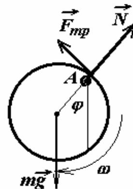
Рассмотрим теперь движение кольца на вертикальном стержне. Для того чтобы кольцо вращалось на постоянной высоте, необходимо, чтобы оно вращалось на стержне без проскальзывания - только в этом случае сила трения будет направлена вертикально вверх и сможет уравновесить силу тяжести.
