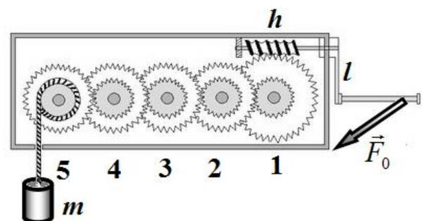
шестерню приводят во вращения с помощью червячного механизма. Ось червяка вращают с помощью ручки, длина плеча которой равна  $l$ . Силу  $F_0$  прикладывают к рукоятке перпендикулярно плечу.
