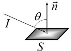
1.2 Однородный световой поток интенсивности  $I$  падает под углом  $\theta$  на плоскую зеркальную пластинку площади  $S$  и полностью отражается от нее. Найдите, чему равен модуль силы светового давления на пластинку. Укажите направление этой силы.
