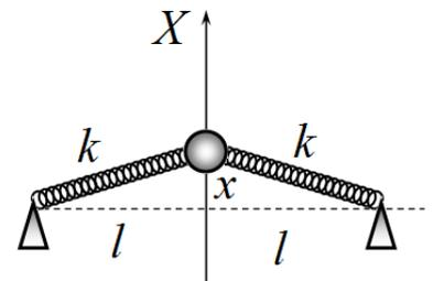
1.1 Найдите зависимость суммарной силы упругости  $F(x)$ , действующей на шарик со стороны 4 пружин, от смещения шарика  $x$ .
