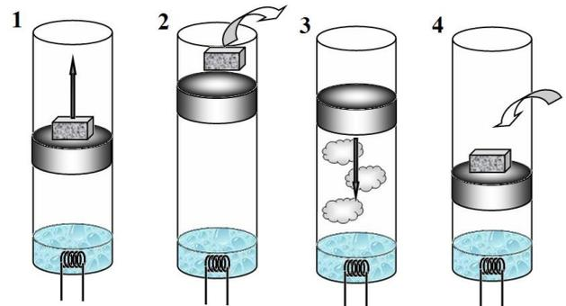
1. На поршне находится груз, включают нагреватель, вода кипит, пар поднимает поршень с грузом.
