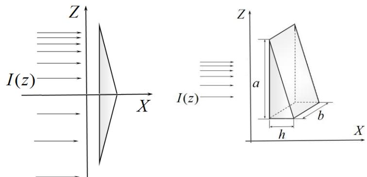
Бипризма находится в воздухе. Показатель преломления материала призмы равен  $n$ . Геометрические размеры призмы  $a, b, h$  показаны на рисунке. Угол при вершине призмы  $\theta$  можно считать малым.
