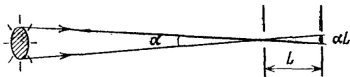
Рис. 2.2. К определению ширины полутени
