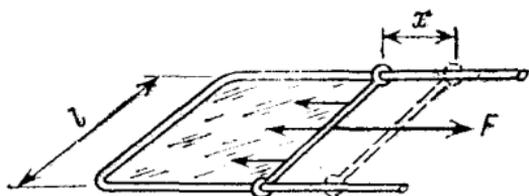
Рис. 20.1. К вычислению поверхностной энергии жидкости
